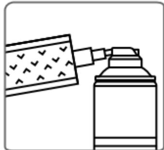
Lubrifier la pièce à main après chaque nettoyage et avant chaque cycle de stérilisation. Henry Schein® recommande d'utiliser Henry Schein® Spray & Clean (102-8721), KaVo Spray ou un spray lubrifiant équivalent.
