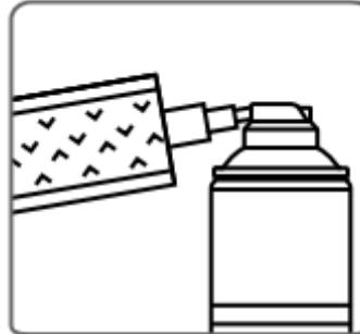
Lubricar la pieza de mano después de cada limpieza y antes de cada ciclo de esterilización. Henry Schein® recomienda usar Henry Schein® spray & Clean (102-8721), KaVo Spray o un espray lubricante equivalente.
